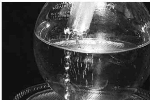
图 5.2.10 有大气泡时,将烧瓶扶正
