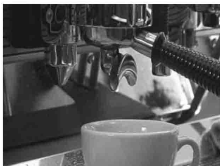
图 4.2.12 将咖啡手柄装上,打开萃取开关
