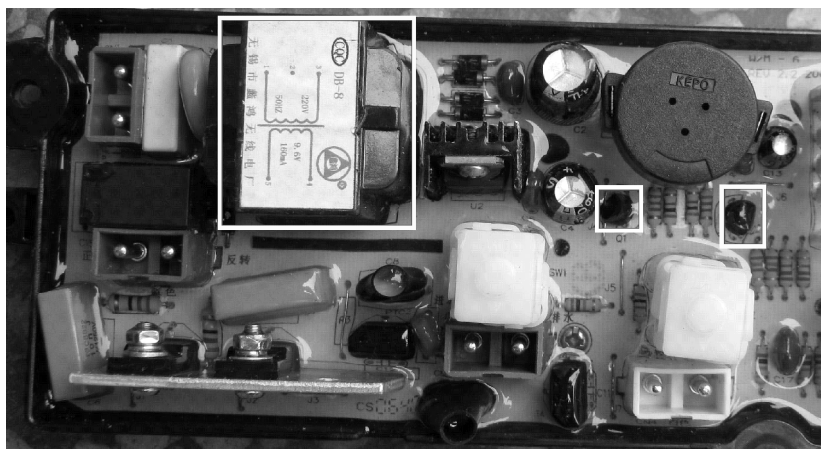
图 2-27 洗衣机电脑板上的电感和电源变压器
