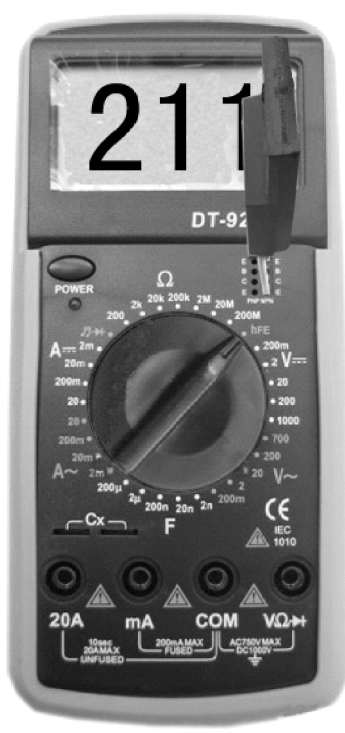
图 3-4 测量晶体管的 h_{FE} 值
