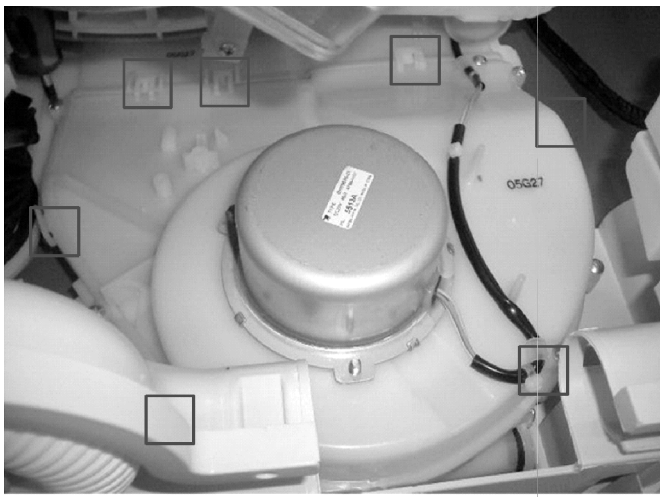
图 3-43 拆卸风扇电动机固定螺钉
