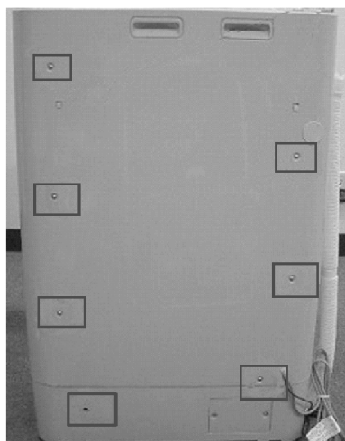
图 3-40 拆卸送风管的固定螺钉
