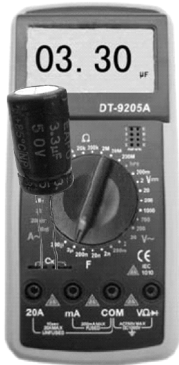
图 3-3 使用数字万用表上的专用插孔测量电容
