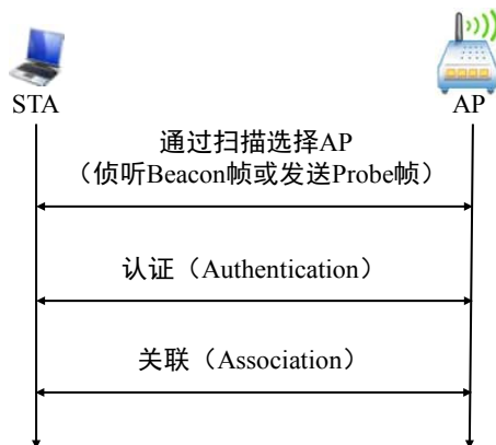
图 5-2 Wi-Fi 连接建立过程
