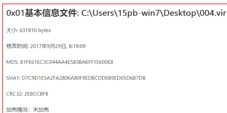
图 14-6 恶意代码的特征码（散列码）示例
