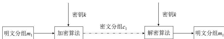
图 2-3 分组密码的工作原理
