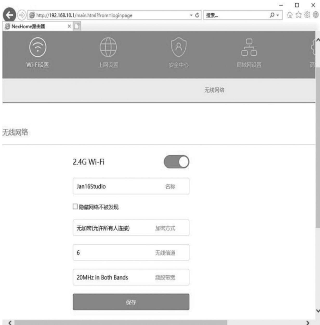
图5-7 按无线规划表5-2配置无线网络
