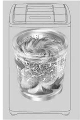
图 1-2 双动力洗衣机旋转示意图
