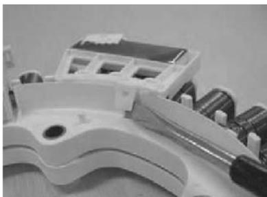
图 6-4 用螺钉旋具拆开霍尔传感器的卡子
