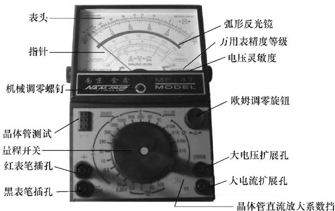
图 5-11 MF47 型指针式万用表外形
