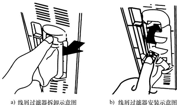
图 2-10 线屑过滤器拆装示意图
