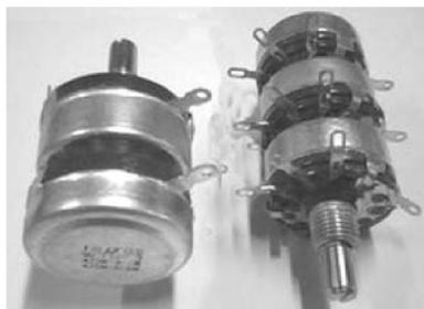
图 4-10 合成碳膜电位器外形
