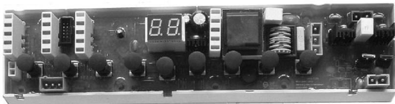
图 6-58 惠而浦 B500C 型波轮式洗衣机电脑板
