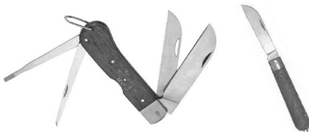
图 5-6 电工刀外形
