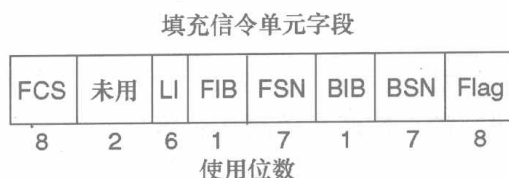
图 4-9 填充信令单元 (Fill-In Signal Unit Fields) 字段
