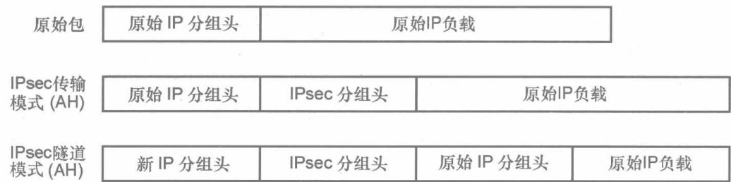
图 10-2 IPSEC –隧道模式和传输模式
