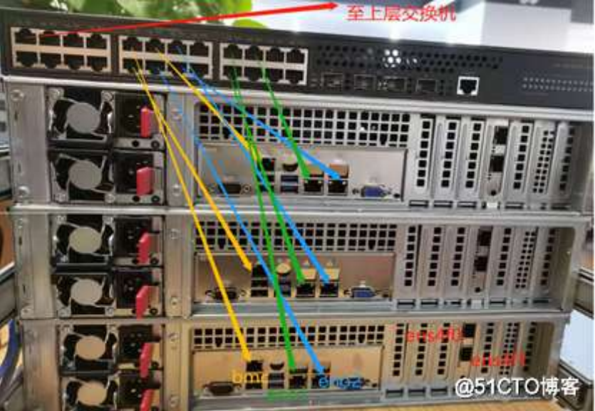
图5. Baixxxx-Cloud-X10服务器网卡规划
