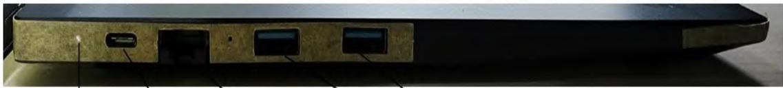
电源状态指示灯 电源插孔 网线接口 USB 接口
