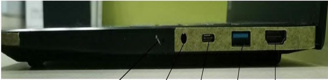
内置麦克风 组合音频插孔 Type-C 接口 USB 接口 连接显示器 / 投影仪
