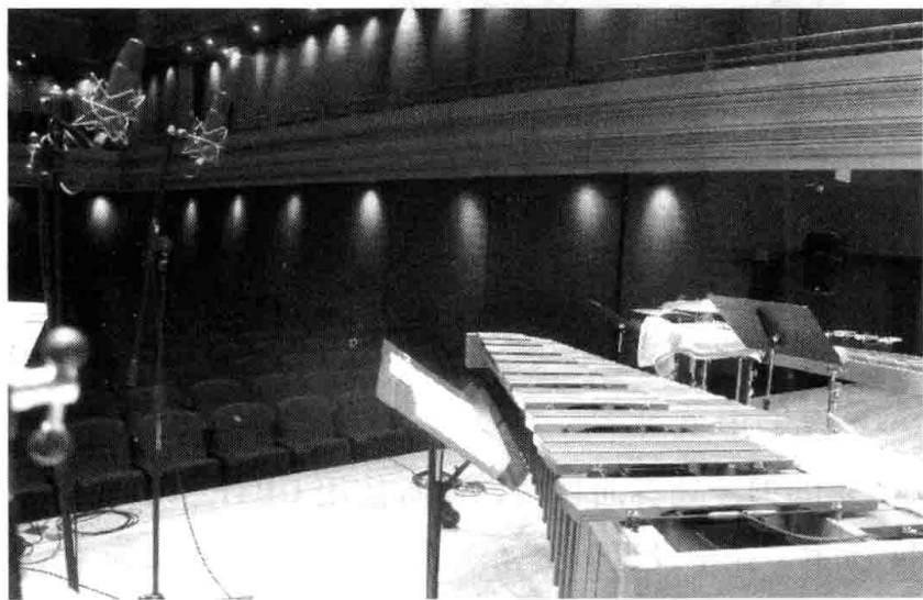
图 9-42 马林巴的麦克风架设方式
