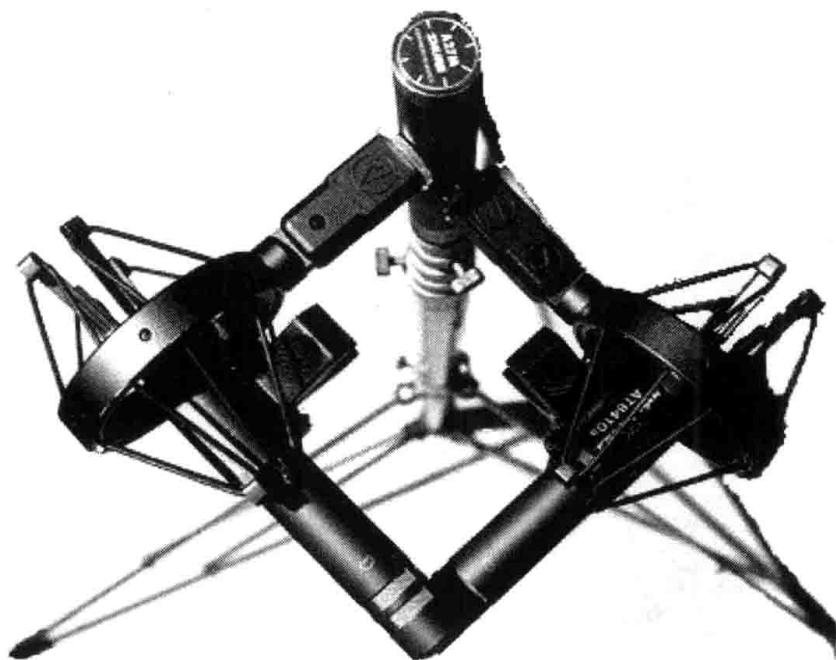
图 8-4 X—Y 麦克风对的架设方式
