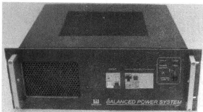
图 5-24 录音室内常用的平衡供电系统
