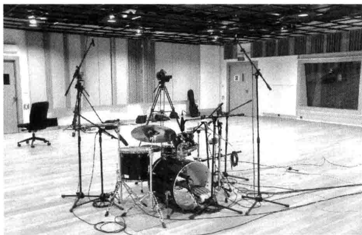
图 9-39 以小军鼓为中心来架设吊镲的麦克风
