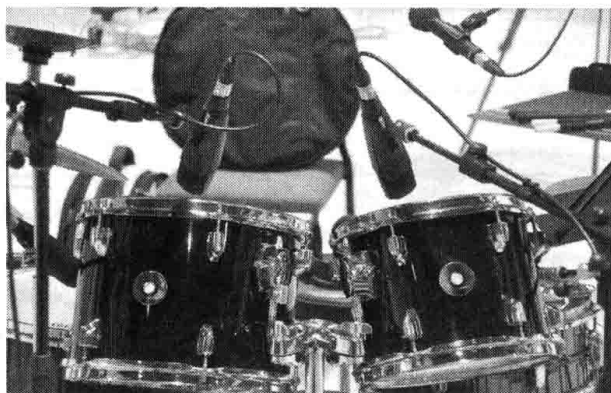
图 9-34 高通和中通鼓的拾取方式
