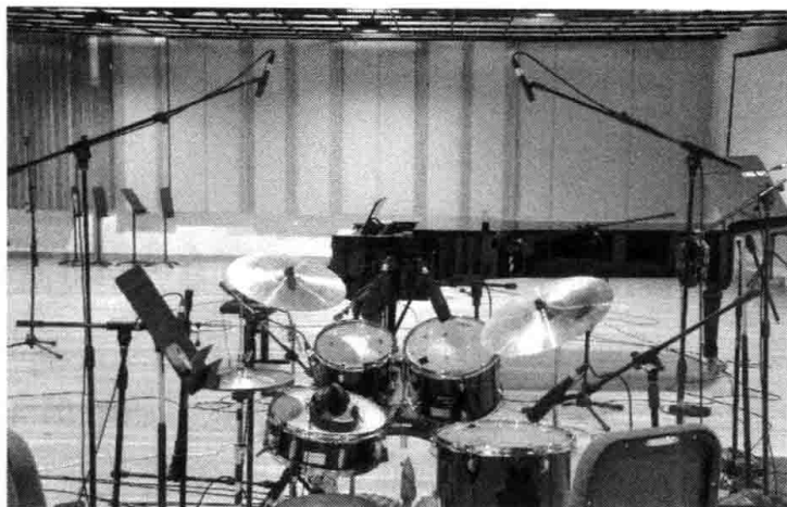
图 9-37 在录制吊镲时，两只麦克风应彼此形成一定角度以避免串音
