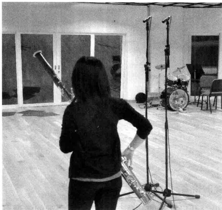
图 9-22 使用小 AB 立体声制式录制大管
