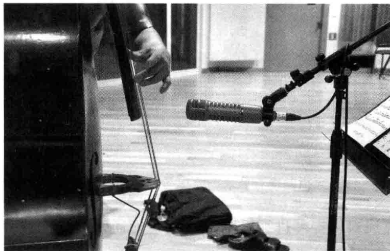
图 9-9 在爵士音乐录音中麦克风和倍大提琴之间的位置关系
