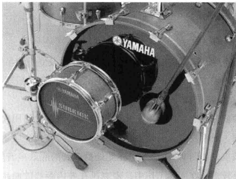
图 9-32 (a) Sub-Kick 和鼓内麦克风共同使用来录制底鼓
