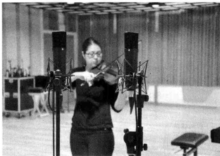
图 9-4 使用 AB 制式录制小提琴古典独奏曲目
