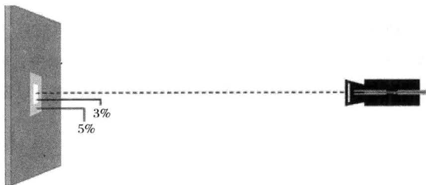
图 8-29 THX 规定的投影仪和屏幕之间的位置关系
