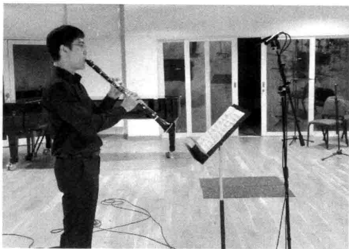
图 9-21 单簧管的录音方式
