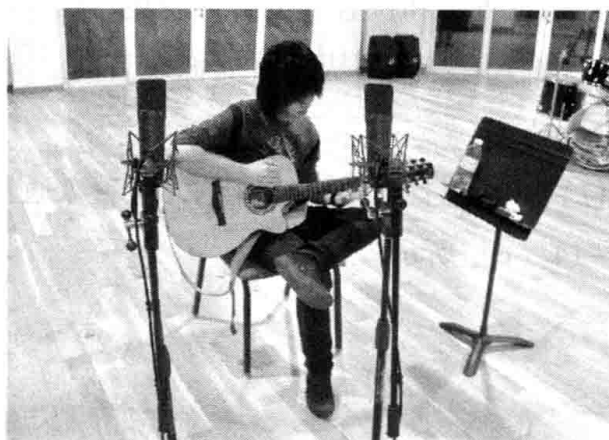
图 9-12 在古典吉他录音中使用 AB 拾音制式以突出声场的听感
