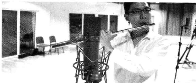
图 9-23 使用单只麦克风对长笛进行录制
