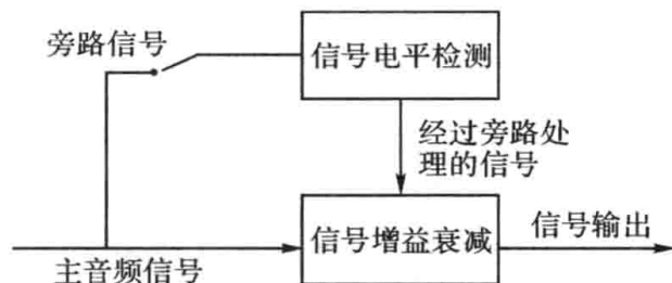
图 5-16 旁路压缩示意图
