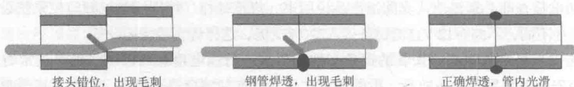
图5-2 钢管接头示意图
