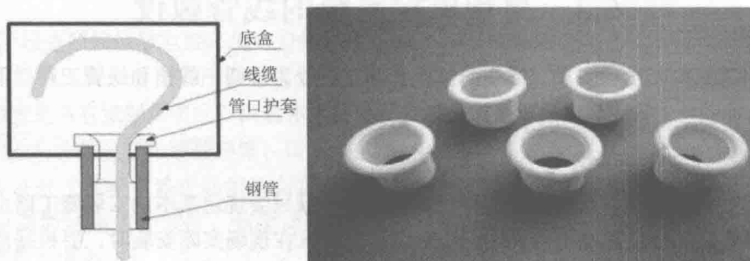
图5-3 钢管端口安装保护套示意图
