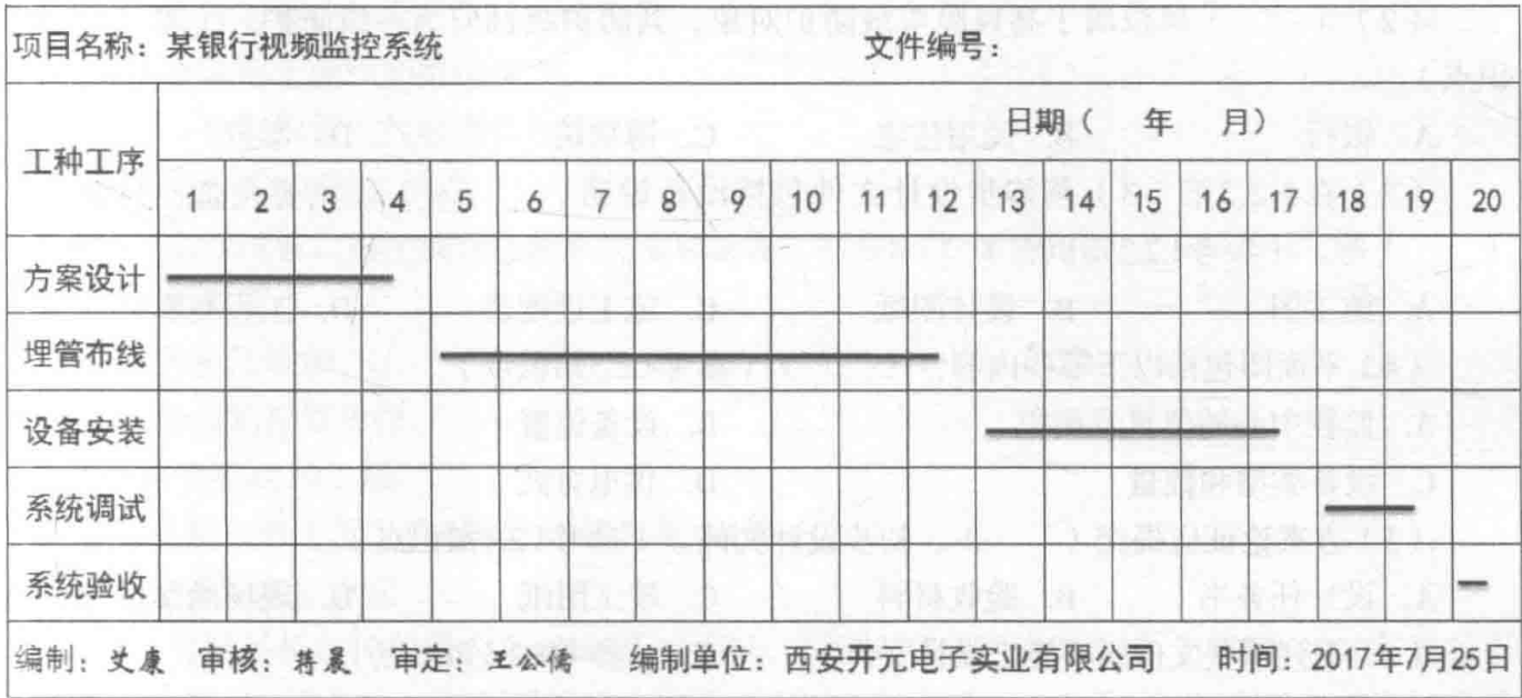
图4-20 某银行视频监控系统施工进度表图
