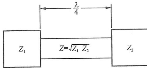
图 6-24  $1/4$  波长短线与不同阻抗的负载连接
