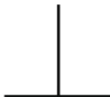
图 7-4 等幅电报信号的频谱图
