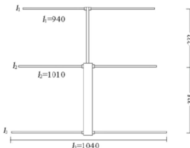
图 12 3 单元八木天线测向机基本尺寸
