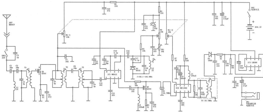
图 24 BA4RC-144MHZ 集成电路测向机电原理图
