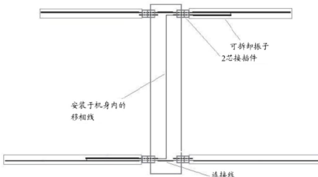
图 22 HB9CV 天线安装连接示意图
