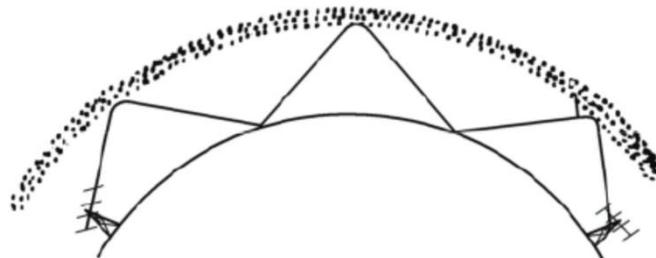
图 5-2 电离层对电波反射的示意图
