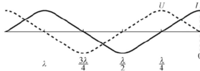
图 6-5 终端短路长线上的驻波
