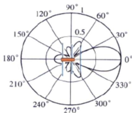
图 13-3 单元八木天线水平面方向图
