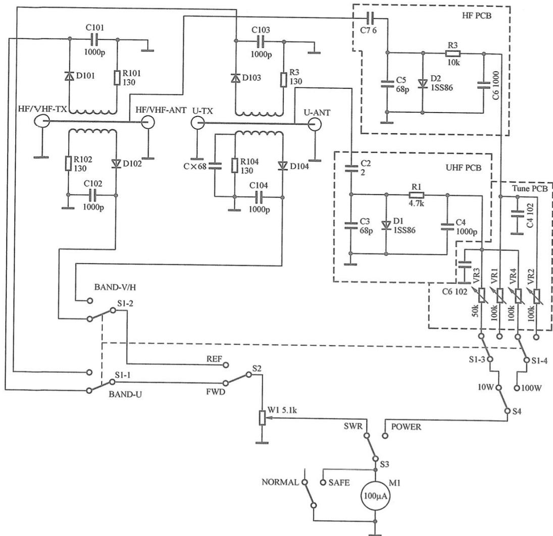
图 7-64 自制 HF/UHF 功率驻波表电原理图
