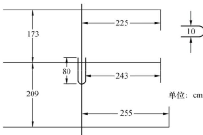
图 6-19 10m 波段 3 单元八木天线的尺寸图
