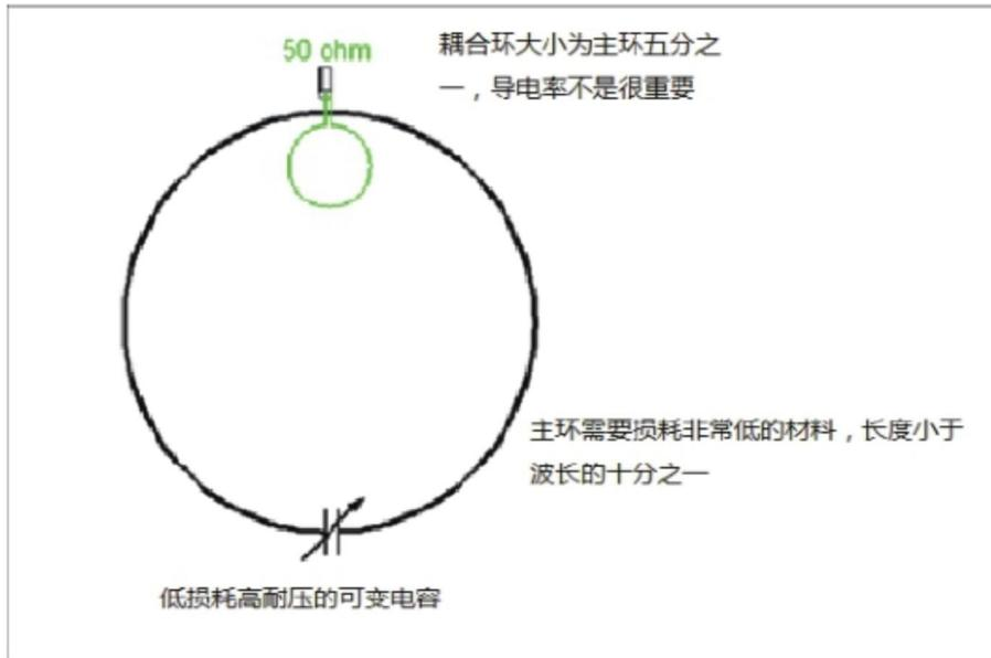
图 6-35 小环天线电气结构原理图
