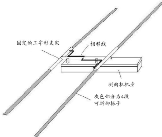
图 15 HB9CV 天线半可拆卸测向机
