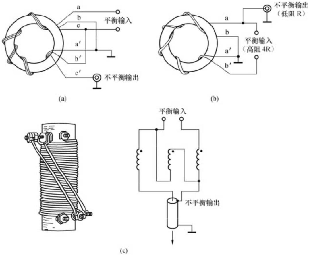
图 6-29 变压器式平衡/不平衡转换器
