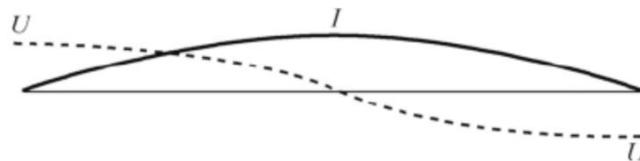
图 6-6 半波天线上电压和电流的分布
