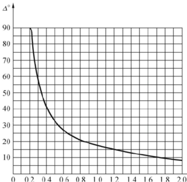
图 6-7 水平对称振子发射仰角和架设高度的关系
