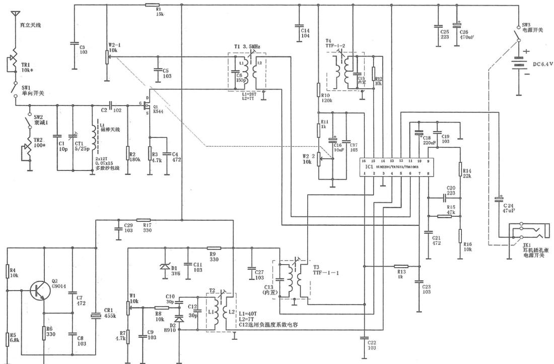
图 23 BA4RC-3.5MHZ 集成电路测向机电原理图
