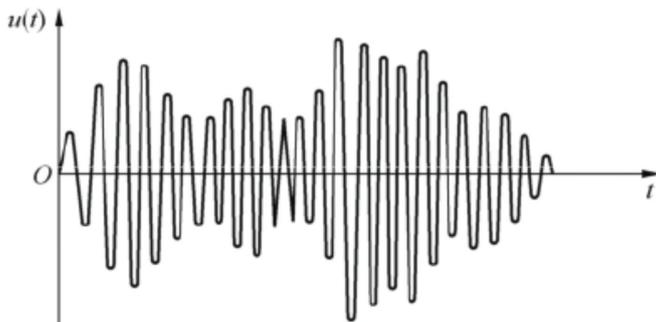
图 7-1 调幅波的波形
