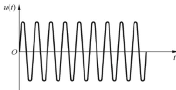
图 7-7 单音调制的单边带信号波形
