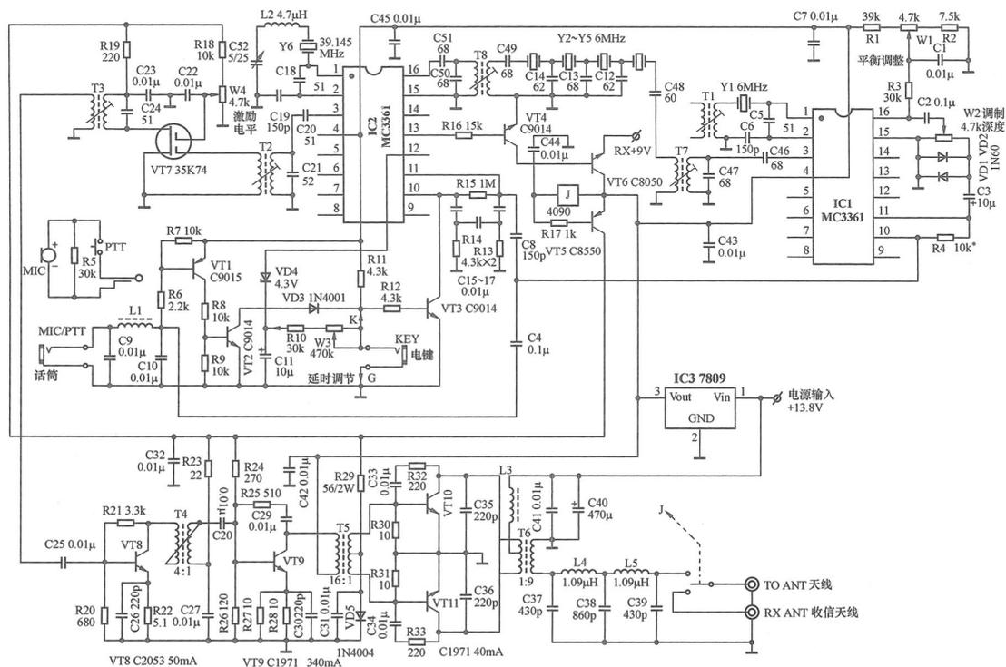
图 7-45 AX94 单边带发信机电原理
