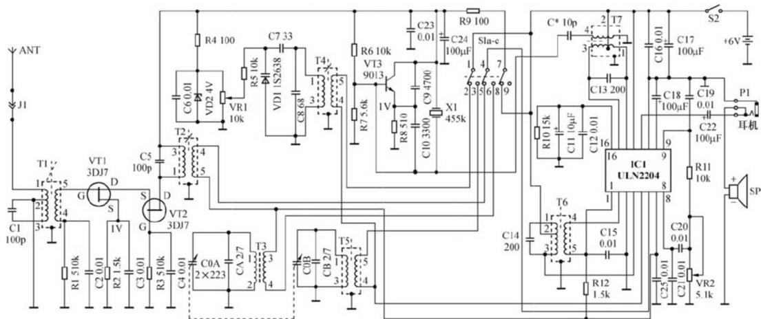
图 7-12 简易两波段收音机电原理图
