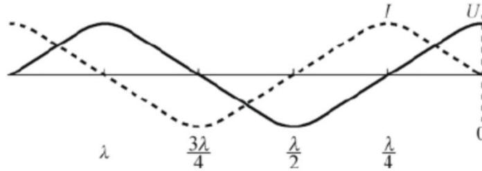
图 6-4 终端开路长线上的驻波
