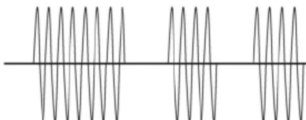
图 7-3 等幅电报信号的波形图
