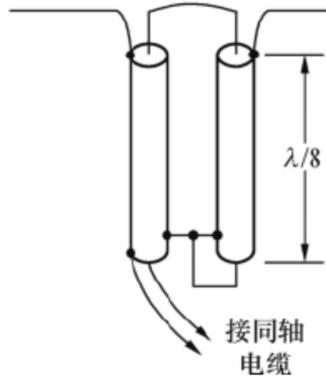
图 6-30 两段 1/8 波长电缆做的转换器
