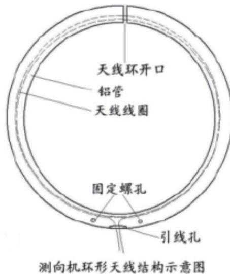
图 2 环形天线的结构
