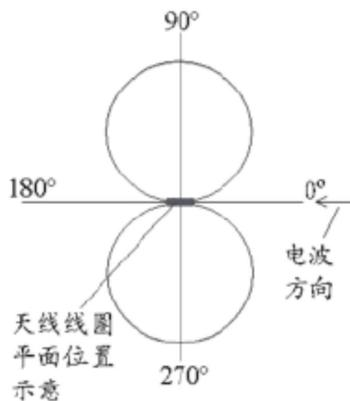
图 9 环/磁棒天线水平面方向图
