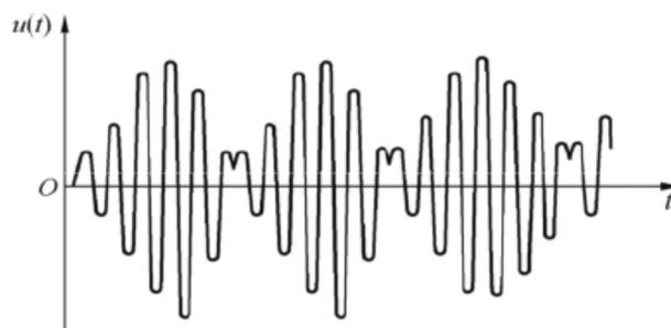
图 7-8 双音调制的单边带信号波形
