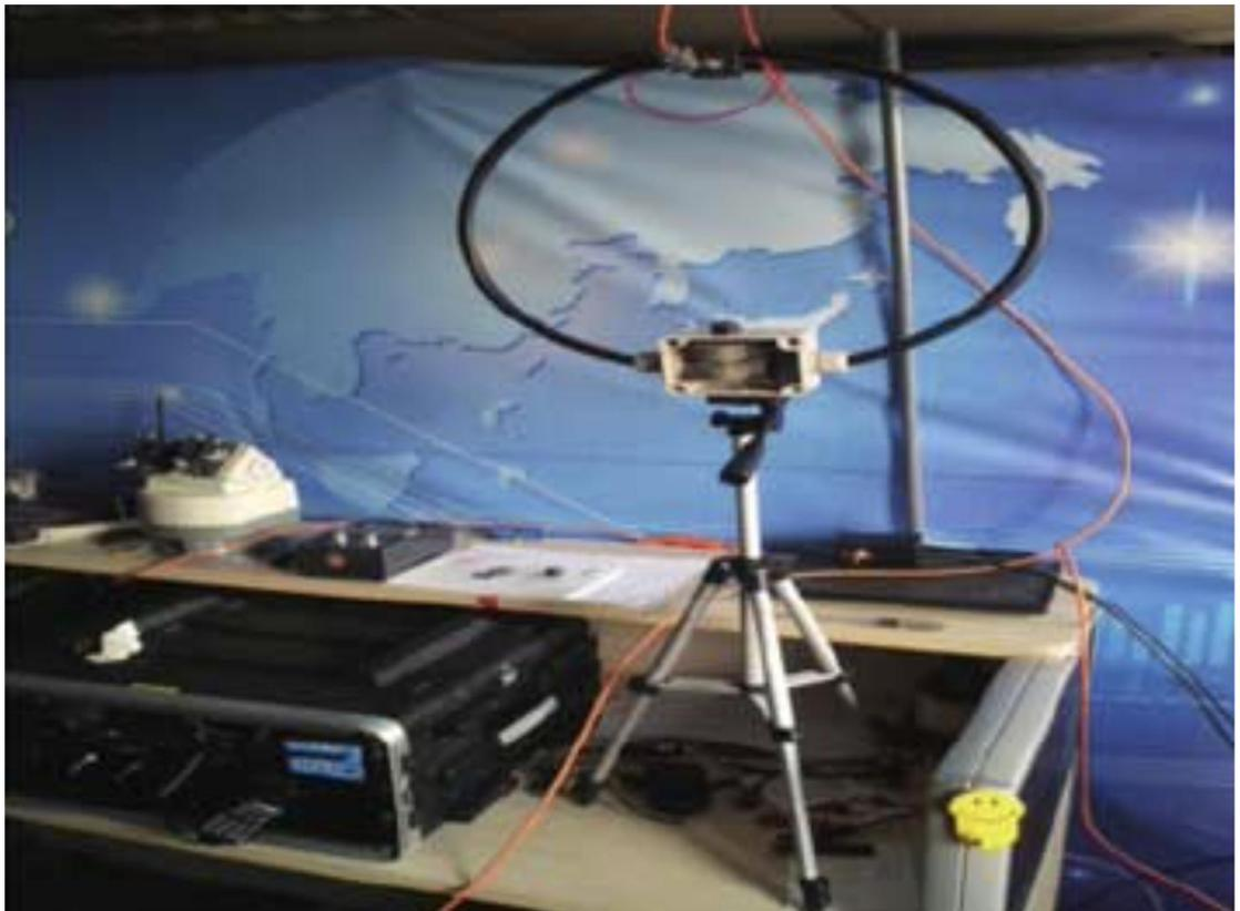
图 6-40 将小环天线固定在三脚架上
