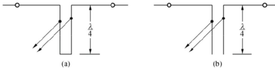
图 6-25 利用  $1/4$  波长短线进行匹配的两种接法
