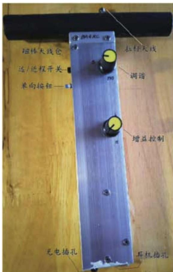
图 3 磁棒天线测向机
