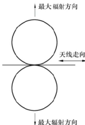
图 6-9 偶极天线的水平面方向图
