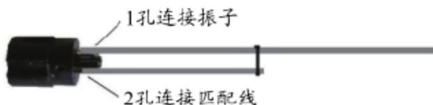
图 18 振子结构
