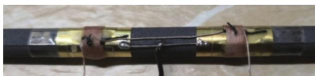
图 6 分段对称绕制于内屏蔽上的线圈
