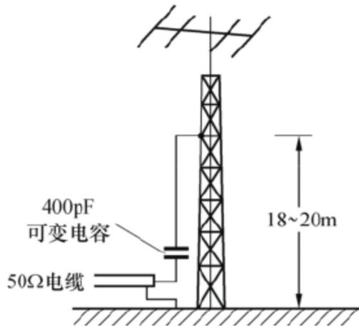
图 6-16 塔架垂直天线的馈电
