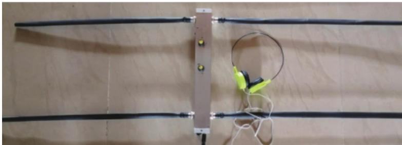
图 16 HB9CV 天线可拆卸测向机
