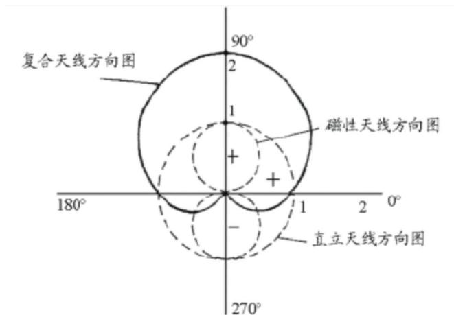
图 10 复合天线水平面方向图
