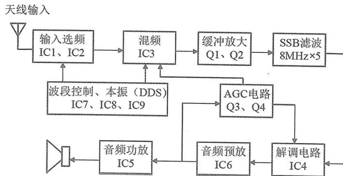
图 7-10 4 波段收音机原理框图
