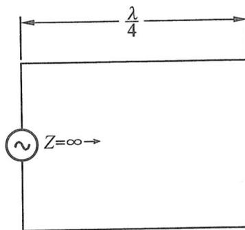
图 6-22  $1/4$  波长短路线
