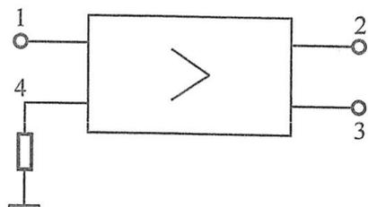
图 7-62 定向耦合器原理示意图
