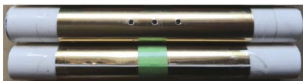
图 5 粘贴于磁棒仓上的外屏蔽
