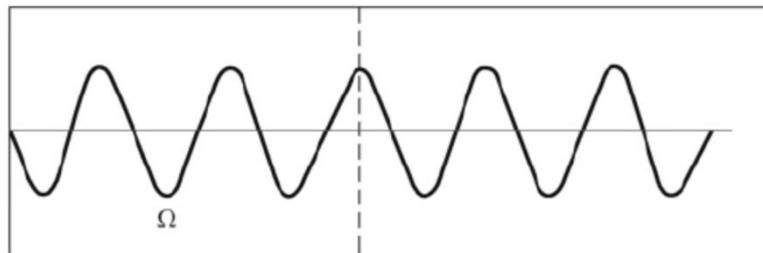
图 6-3 反射波和入射波合成示意图
