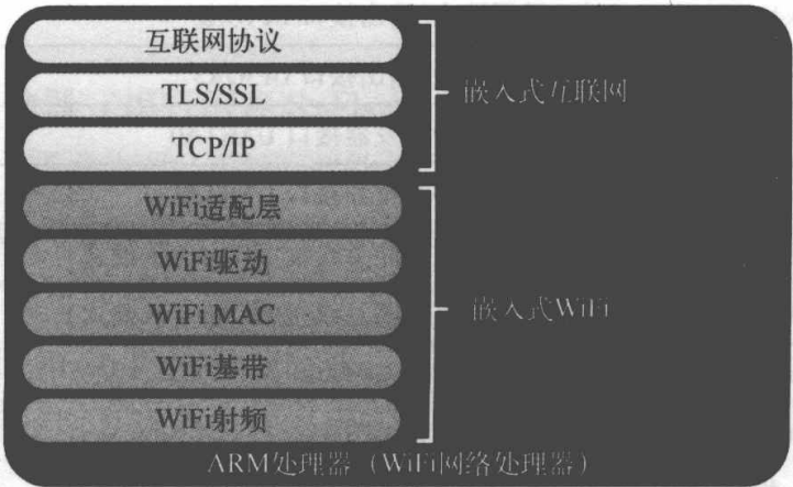
图 3.3 CC3200 的 WiFi 网络处理器内部结构
