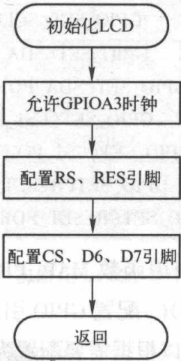
图 10.14 初始化 LCD 的程序设计流程
