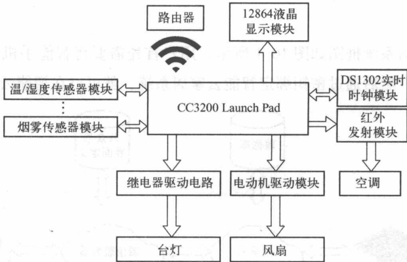
图 10.2 远程智能云家居系统的硬件组成框图
