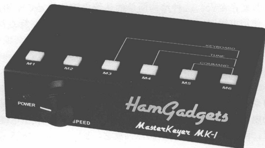
图 2-3 今天大部分 CW 爱好者都有这样的键控器，用于高速 CW 通信。键控器与单（双）桨电键连接，可以自动生成点、划信号。转动键控器前面的速度旋钮，可以改变电码的发送速度。目前市售的各种键控器，例如图中所示的 HamGadgets 公司的 MasterKeyer MK-1 键控器，往往具有多种附加功能，例如存储信息的功能。
