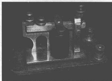
图6-1 早期的电报发声器，可以发出连续的“咔”声，有经验的报务员可以根据“咔”声，判断是点信号，还是划信号。
