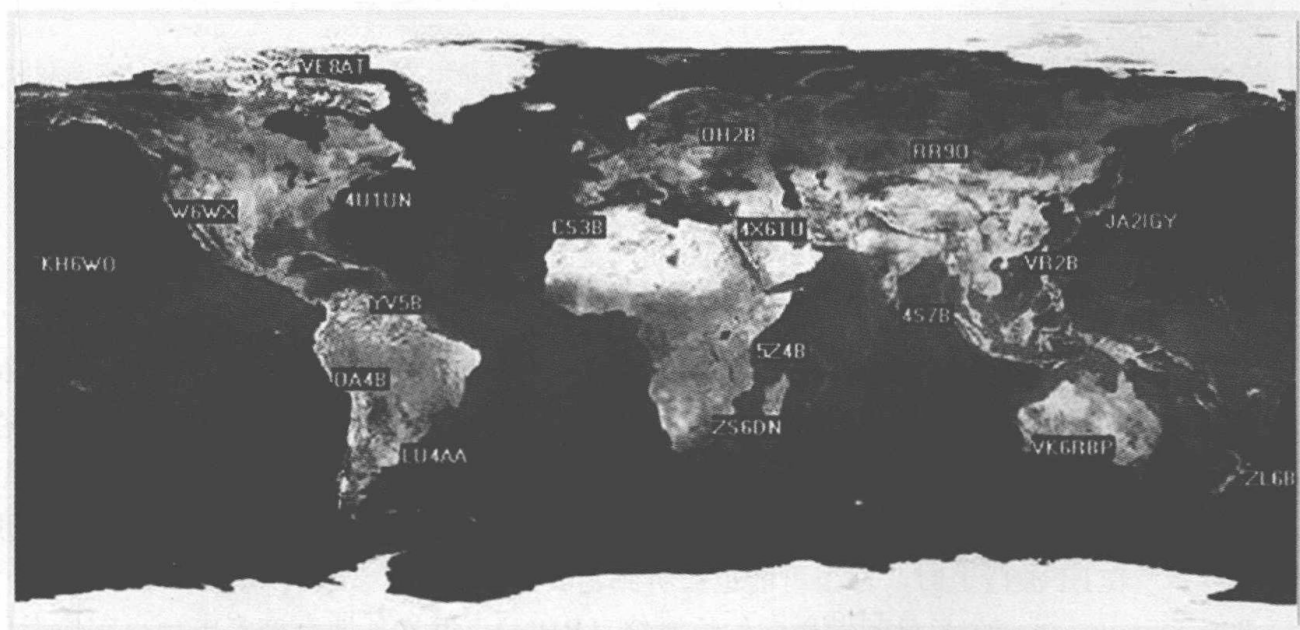
图 3-1 国际信标计划 (IBP) 提供了一种高效方法, 让你能够立即了解你所在的地方与全球 18 个地方之间的传播情况是好是坏。IBP 电台在 14.100MHz、18.110MHz、21.150MHz、24.930MHz 和 28.200MHz 这 5 个频点工作。
