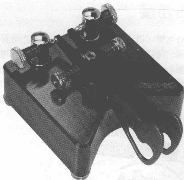
图 4-6 这个自动电键有两个桨片。左边的桨片生成点信号，右边的桨片生成划信号。 这个自动电键允许两个手指同时挤压两个桨片，在支持短长格拍发的键控器的配合下，连续拍发交替的点、划信号。
