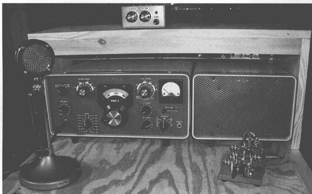
图 6-7 经典的 Collins KWM-2 收发信一体机，它将单独的收信机和单独的发信机组合在一起，支持SSB和CW模式。这款机器最初是为移动语音通信设计的，为了同时支持CW通信，设计上做了一些妥协。[照片由理查德·比泽（WB2ZKW）提供]
