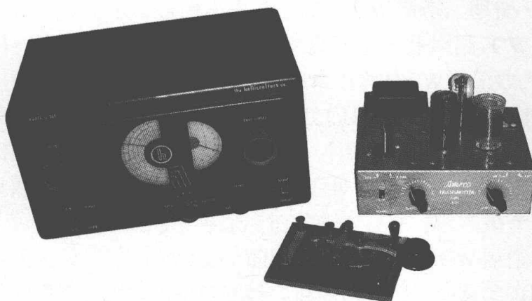
图 6-6 20 世纪 50 年代的 Novice CW 电台，包括一个 Ameco AC-1 发射机、一个 Hallicrafters S-38A 接收机和一个经典的 J-38 手键。[照片由约翰·迪尔克斯（K2TQN）提供]
