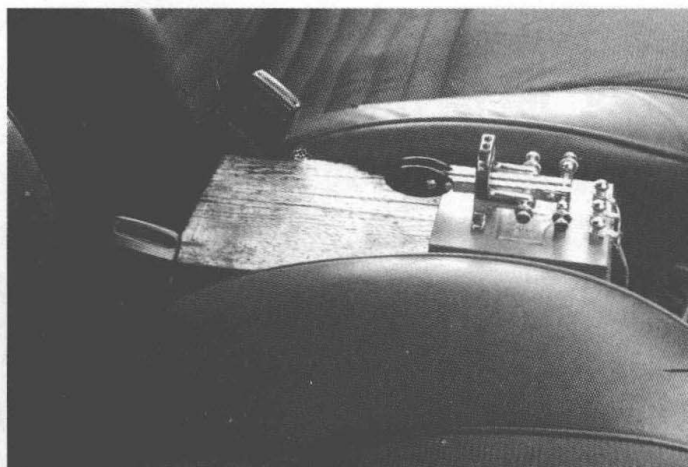
图 5-1 移动 CW 电台与其他移动电台非常相似，只不过桨式自动电键必须安装在既能让操作者感到方便、舒适，又非常牢固的位置上。[照片由罗杰·伯奇（WF4N）提供]
