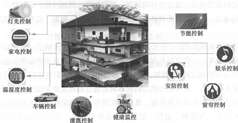
图1-3 典型智能家居系统构成示意图
