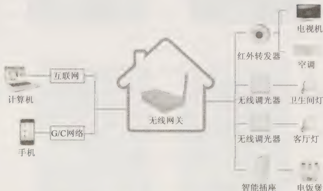
图4-10 用计算机和手机代替遥控器控制家电的拓扑图
