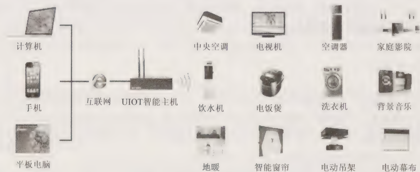
图4-1 智能家电控制示意图
