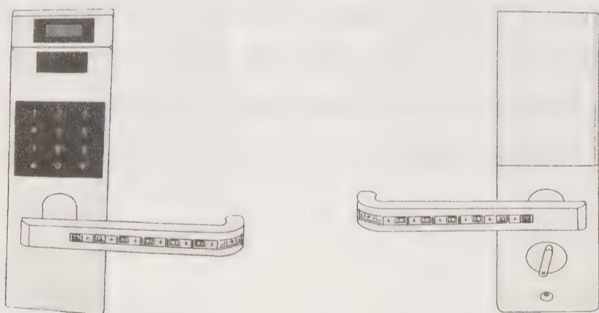
图5-8 门锁前、后面板整体安装示意图
