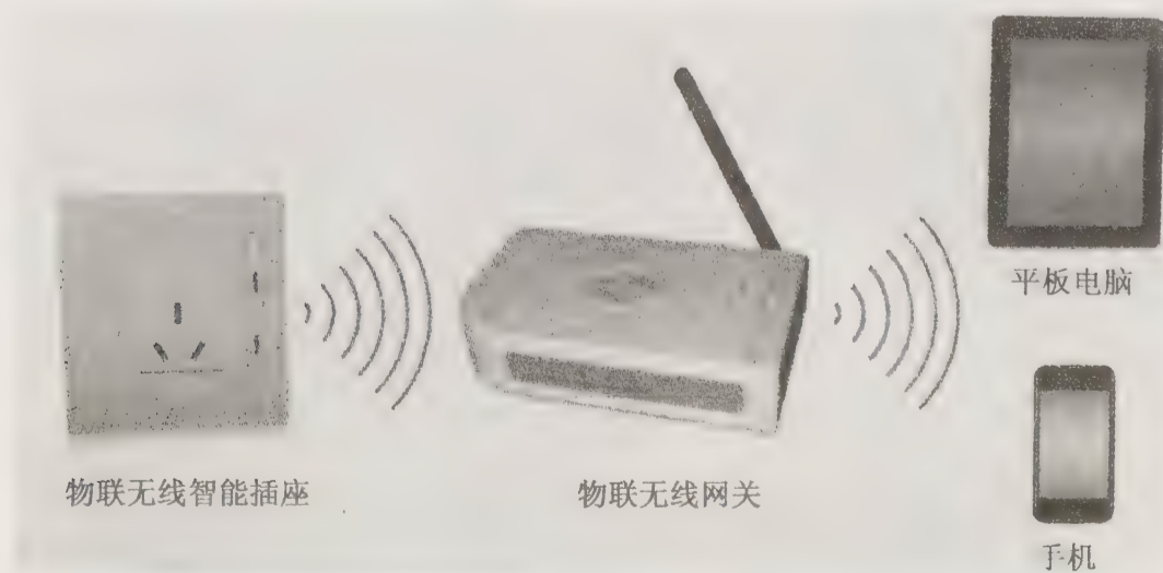
图2-19 智能插座与物联无线网关配套使用
