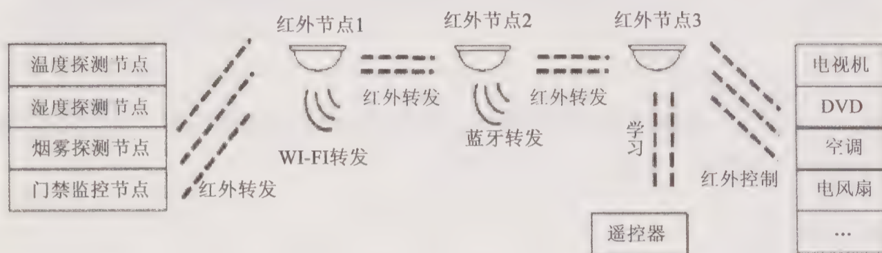
图4-31 红外转发系统的框架图
