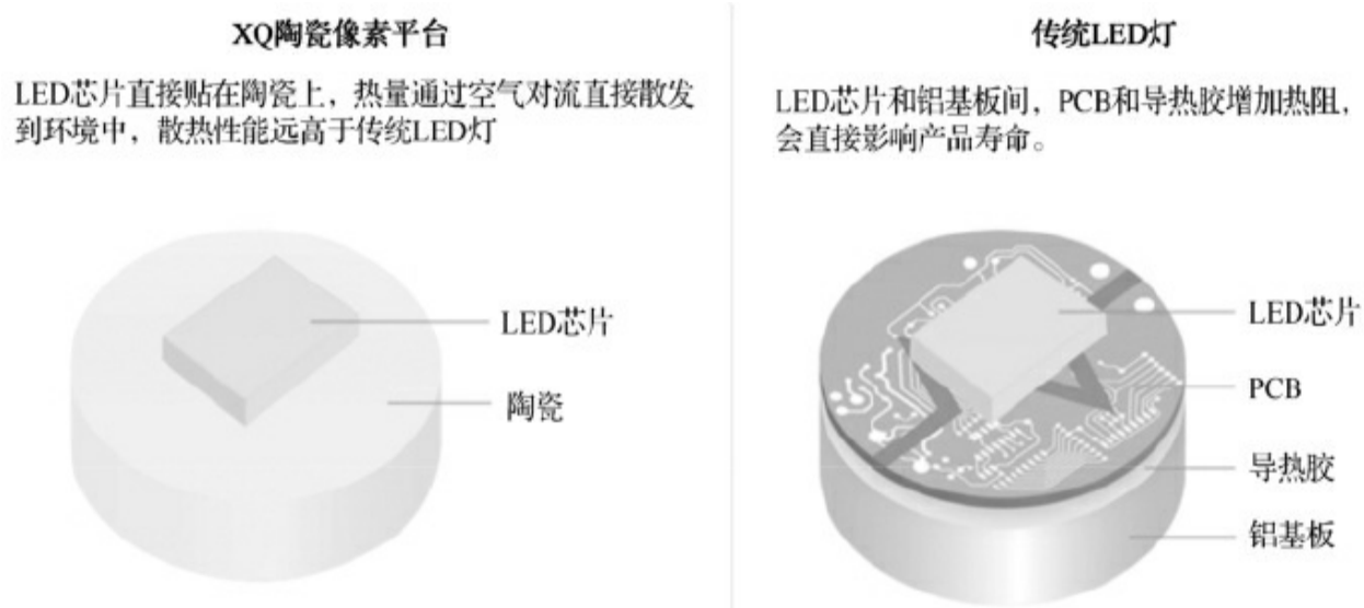
图6-14 三思全彩灯泡陶瓷像素平台与传统LED灯泡平台的对比
