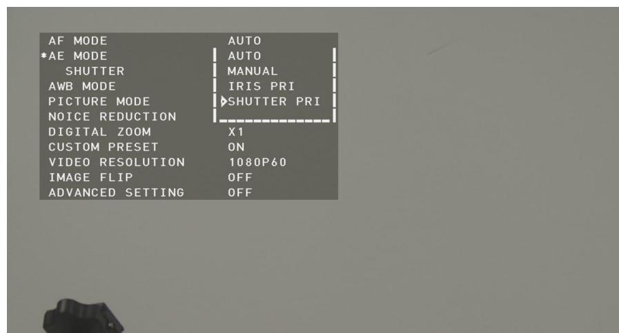
步骤3 按左键回退到上一级, 将SHUTTER调整为1/100, 如图3-43所示, 点OK确定。
