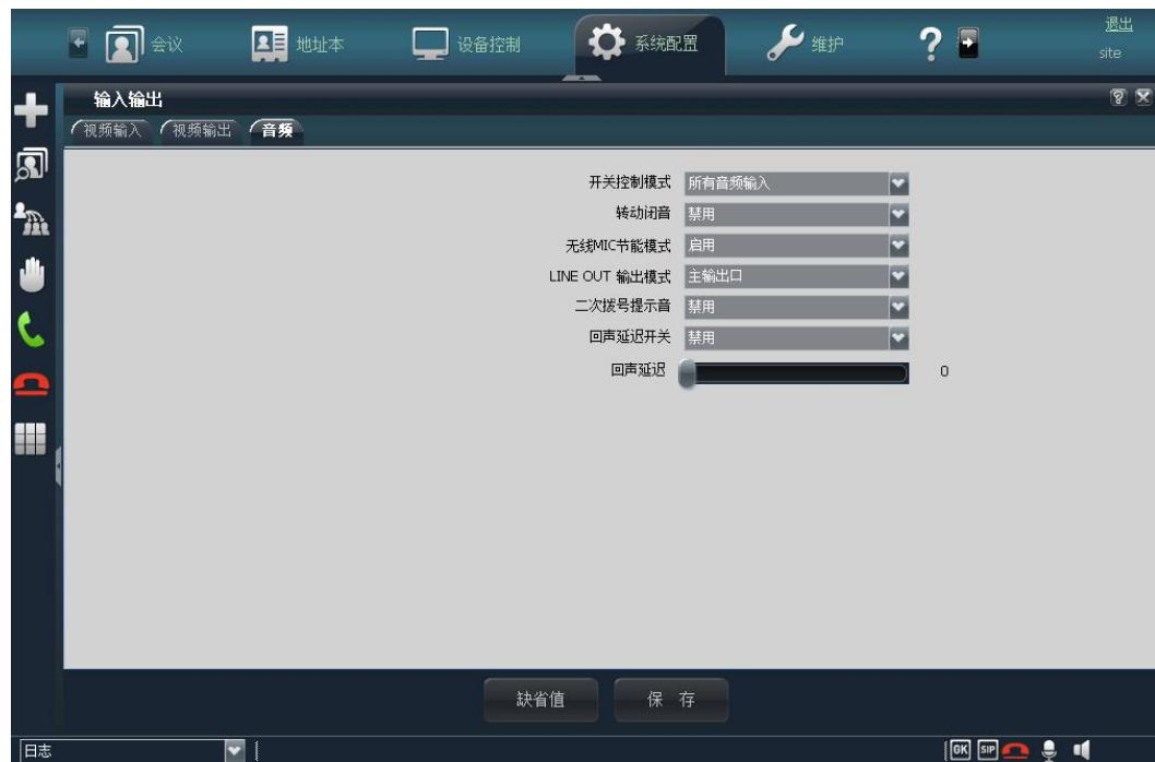
原因：目前版本没法实现终端自动识别回音，必须精准匹配音频输出延迟，若延迟大于300ms则无法满足。
