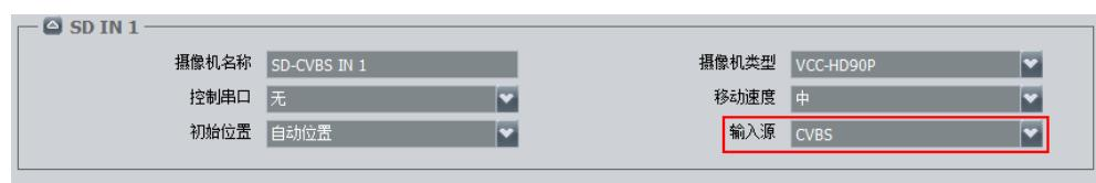
**步骤3** 在终端Web页面，选择“设备控制 > 设备控制 > 视频控制”，如图3-4所示，在“视频输入源”区域框中，设置“主视频源”为图3-3“SD IN 1”区域中对应的“摄像机名称”。
