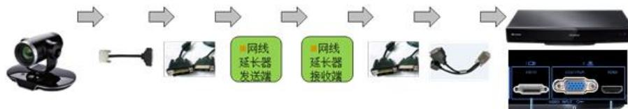
b. 控制线延长方法：采用串口控制线（04050118）+网线延长线（04050174），接线示意如图4-15所示。
