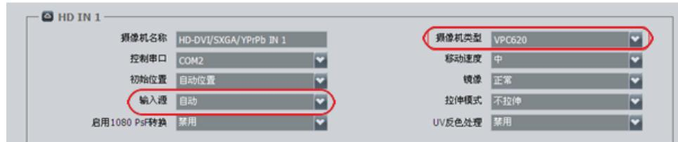
2. 参数配置正确后，若视频监控看到的输入口图像仍然偏色，则更换摄像机所连接的终端输入口，按照**步骤1**继续排查。
