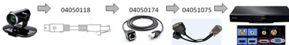
此时的控制线是接到04051075的网线口，终端侧COM口不需要连线。终端侧HD-VI设置的控制串口保持默认COM2。
