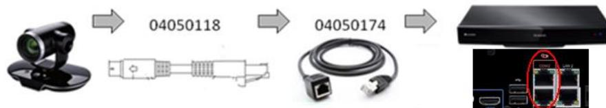
此时的控制线是连接到终端的COM口（不使用04051075这根线缆），且要登录终端Web，选择“系统配置 > 输入输出 > 视频输入”，设置SDI IN的“控制串口”为相应的串口。
