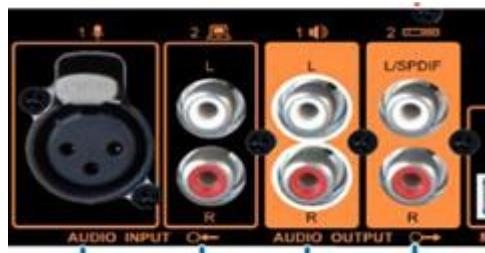
如**图2-2**所示，TE终端的AUDIO OUTPUT有两路输出：
