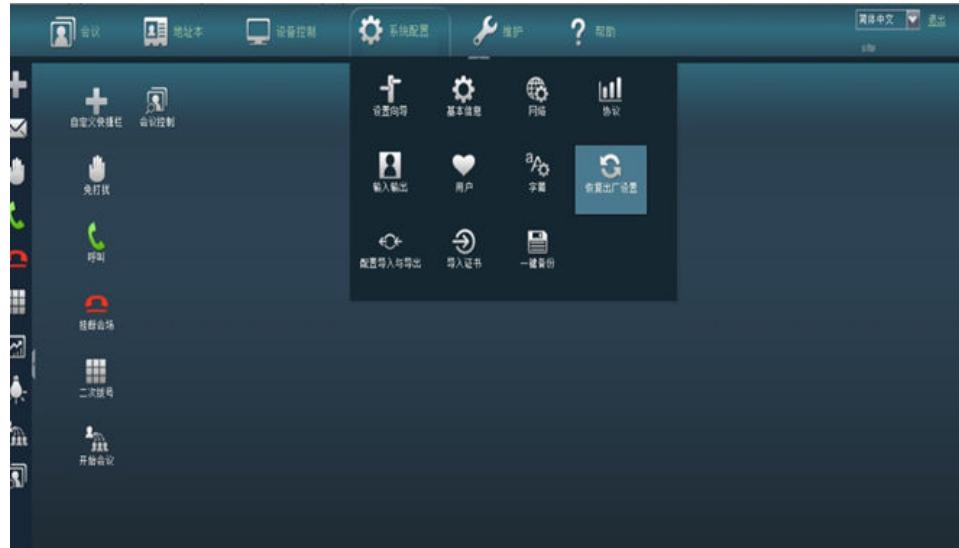
**步骤2** TE系列终端（含TE30/TE40/TE50/TE60）通过Web登陆恢复出厂值：PC登录终端Web界面后依次选择“系统配置 > 安装 > 恢复出厂设置”，然后输入终端序列号，终端即可恢复出厂值并会自动重启。恢复出厂值后，终端的默认IP为192.168.1.1。
