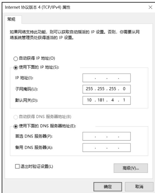
图 7-2-4 “Internet 协议版本 4 (TCP/IPv4) 属性”对话框
