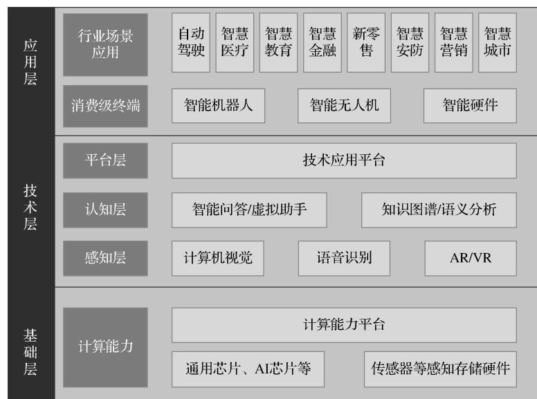
图 1-6-3 人工智能技术整体架构
