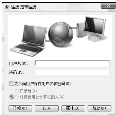
图 7-2-9 使用 ADSL 拨号连接接入 Internet
