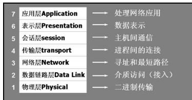
图 7-1-8 OSI 七层网络模型
