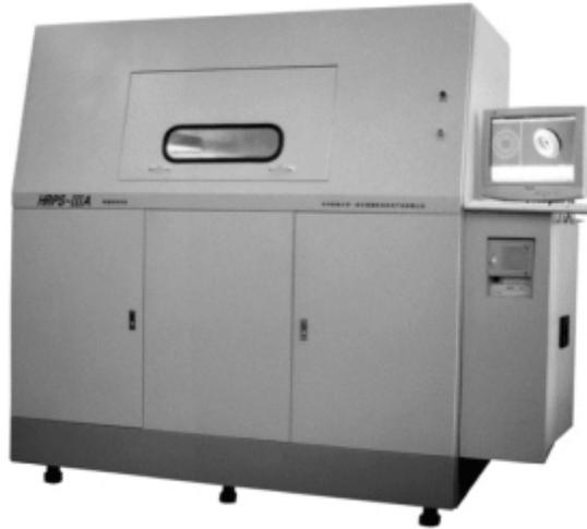
图2-89 HRPS-III A激光粉末烧结快速成型机
