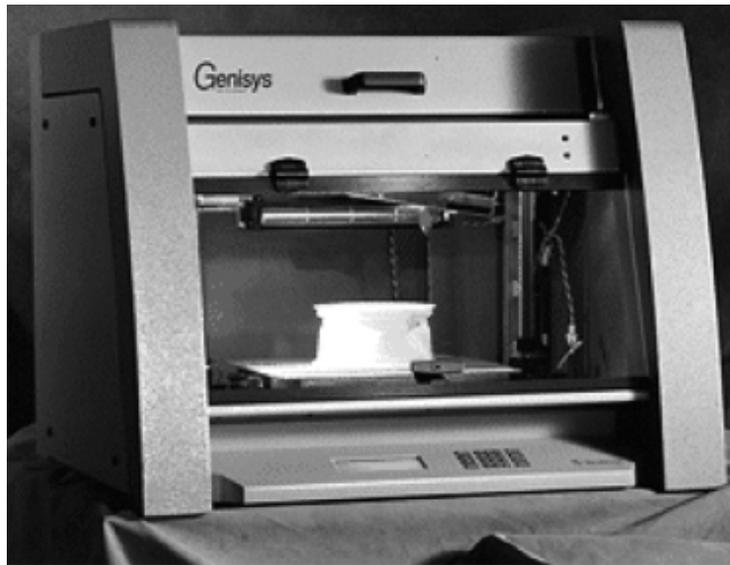
图2-67 Stratasys公司于1993年开发出的第一台FDM1650机型（尺寸：254 mm×254 mm×254 mm）
