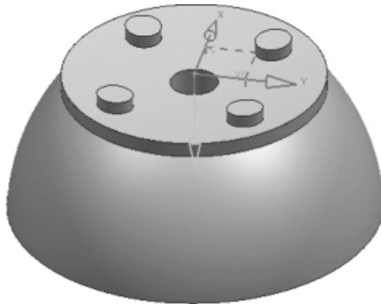
图2-161 生成圆柱孔后的实物
