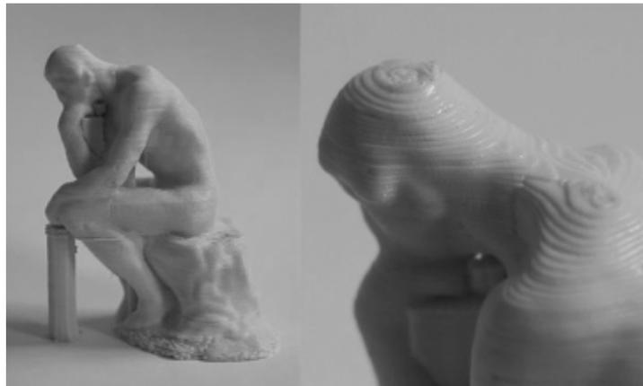
图1-15 3D打印产品呈现的台阶效应
