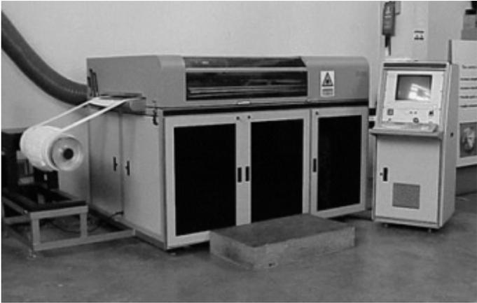
图2-135 Helisys公司的LOM-2030机型
