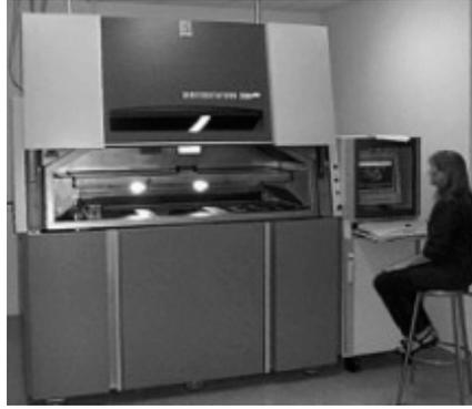
图2-88 DTM公司的SinterStation2500Plus机型
