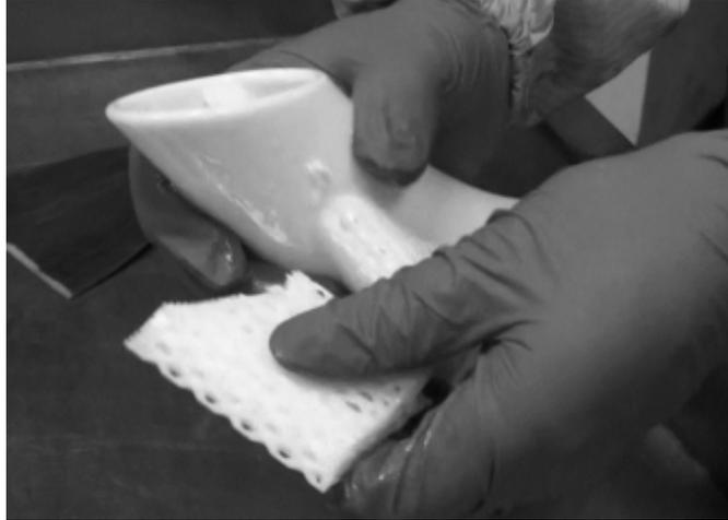
图3-44 手剥去除音箱外部支撑
