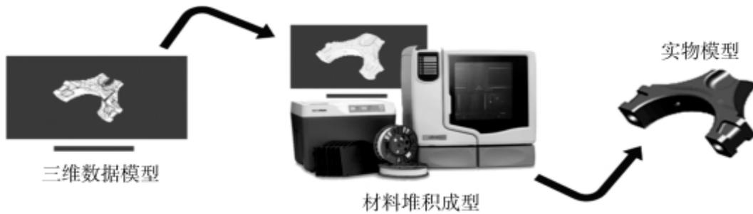
图1-4 快速成型制造模型的过程
