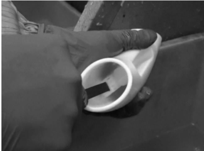
图3-47 用小刮刀去除内部悬空部分的支撑
