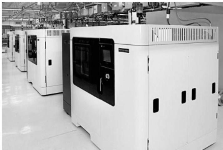
图1-9 工业级3D打印机
