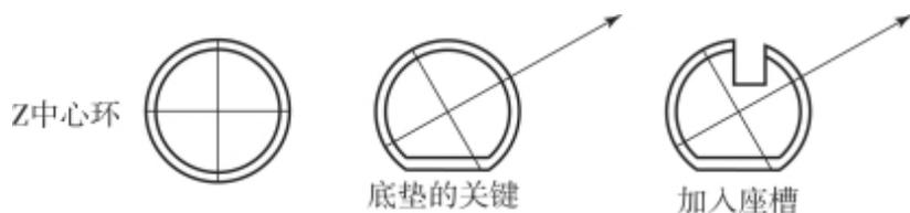
图3-7 手机座槽位置和底垫的关键
