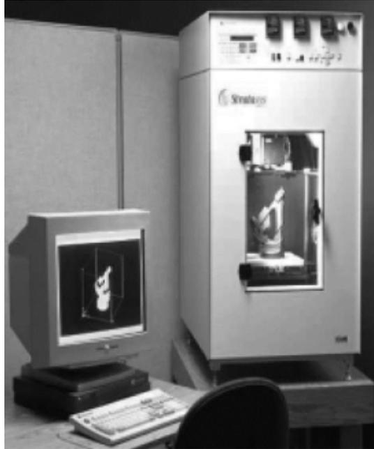
图2-66 Stratasys公司的FDM-Genisys Xs机型（尺寸：305 mm×203 mm×203 mm）
