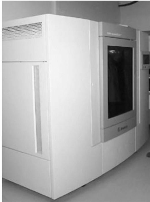
图2-65 Stratasys公司的FDM-Quantum机型（尺寸：600 mm×500 mm×600 mm）
