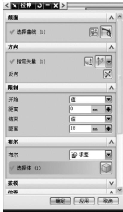
图2-159 圆柱孔的设置
