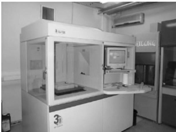
图2-12 3D Systems公司的SLA7000机型
