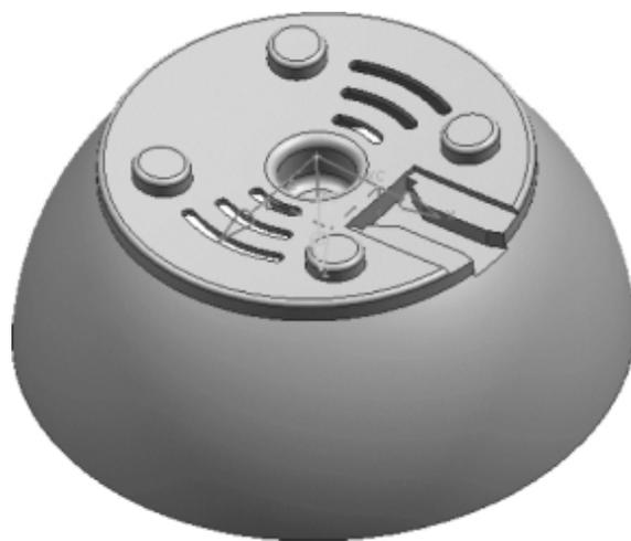
图2-180 生成穿线孔后的实物
