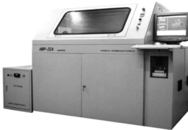
图2-138 HRP系列薄材叠层快速成型机
