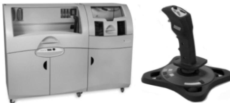
图2-115 ZCorp公司的Z650设备及其制作的彩色模型
