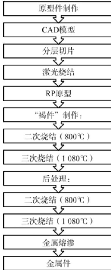
图2-91 基于SLS工艺的金属零件制造过程
