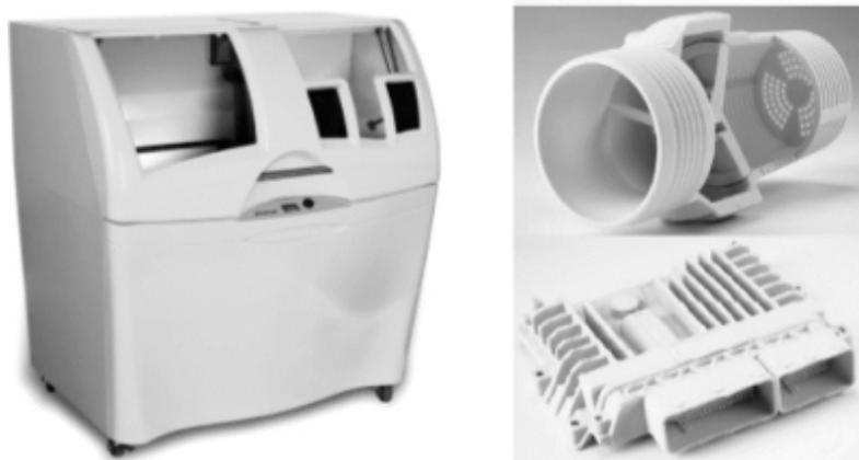
图2-114 ZCorp公司的Z350设备及其制作的白色模型
