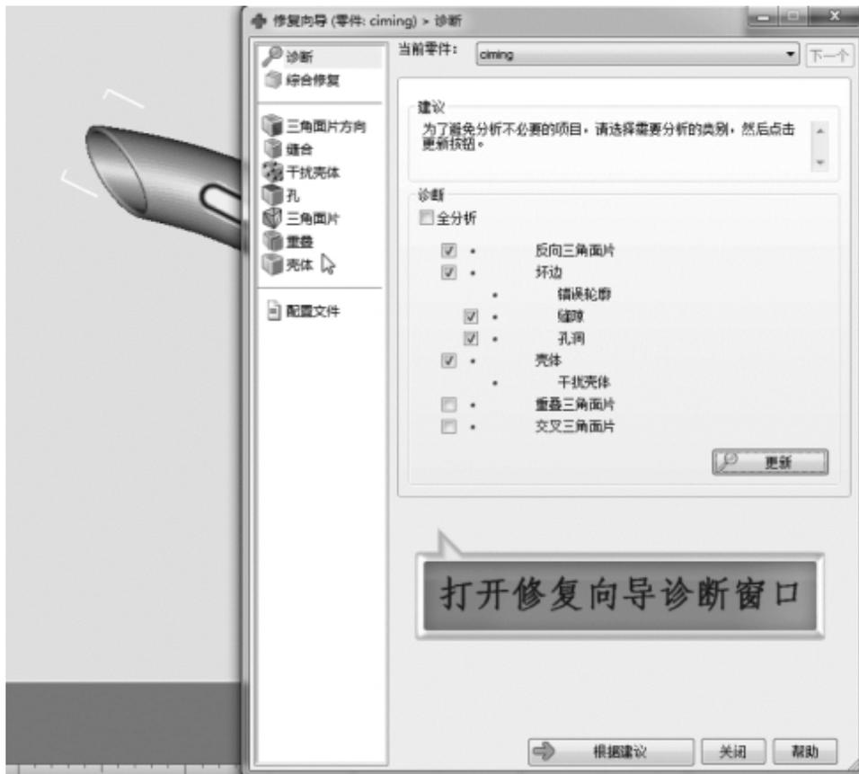
图3-32 对导入数据进行诊断和修复
