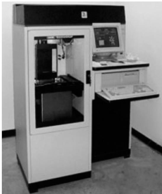
图2-9 3D Systems公司的SLA250机型
