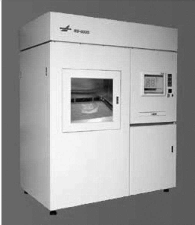
图2-17 上海联泰公司的RS-600S光固化成型机
