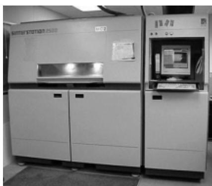
图2-87 DTM公司的SinterStation2500机型
