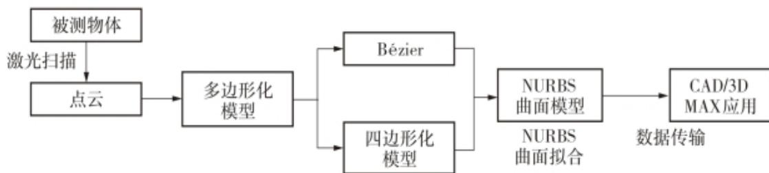
图5-2-1 曲面重建流程图
