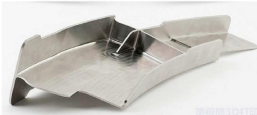
图4-3-5 钛金属飞机机翼部件（图片来源：西北工业大学）
