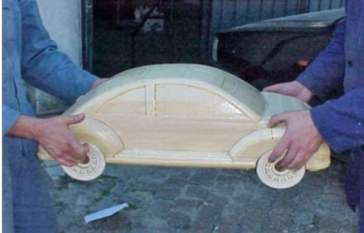
图2-5-3 LOM工艺制造的汽车模型
