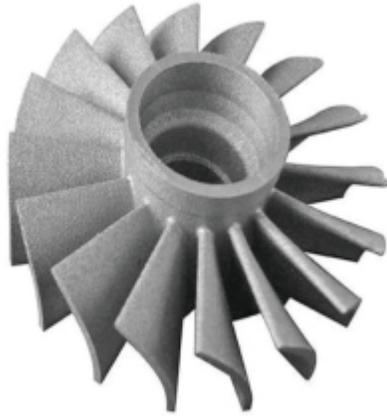
图2-2-2 SLS工艺打印的叶轮
