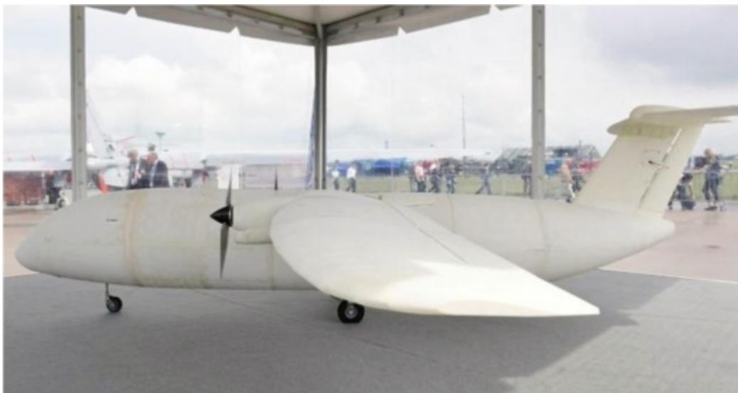
图1-3-1 3D打印飞机
