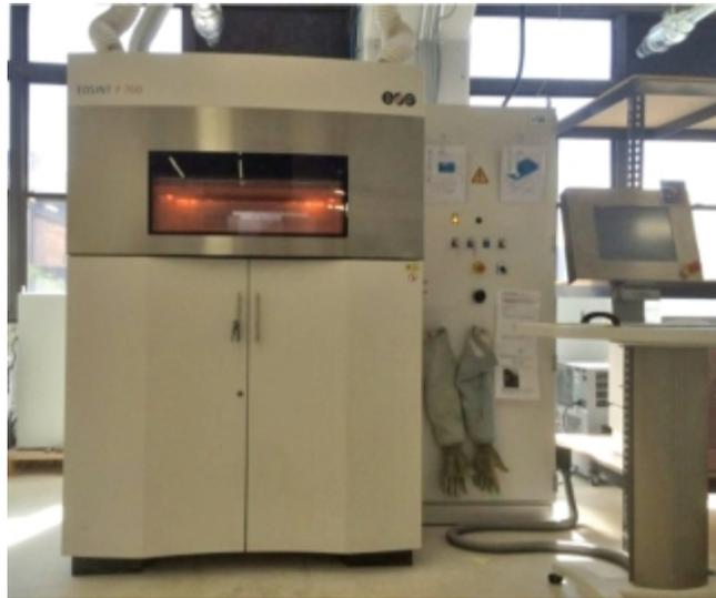
图1-2-7 SLS型3D打印机
