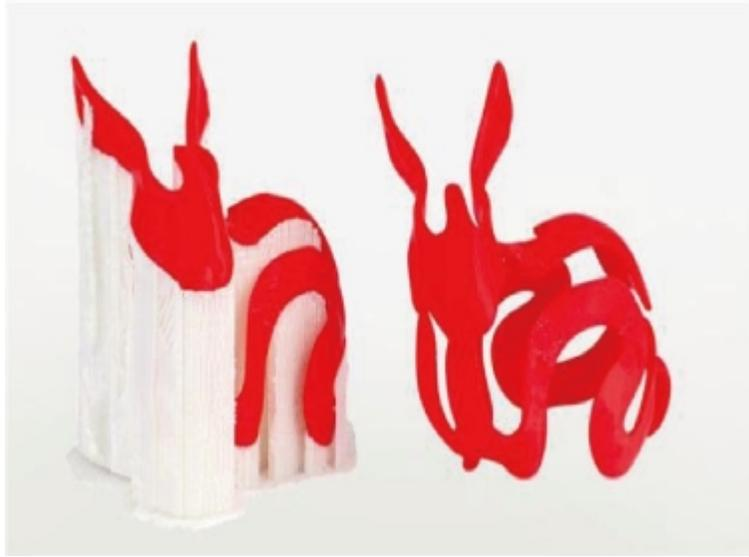
图2-1-3 FDM工艺打印的模型与水溶性支撑材料
