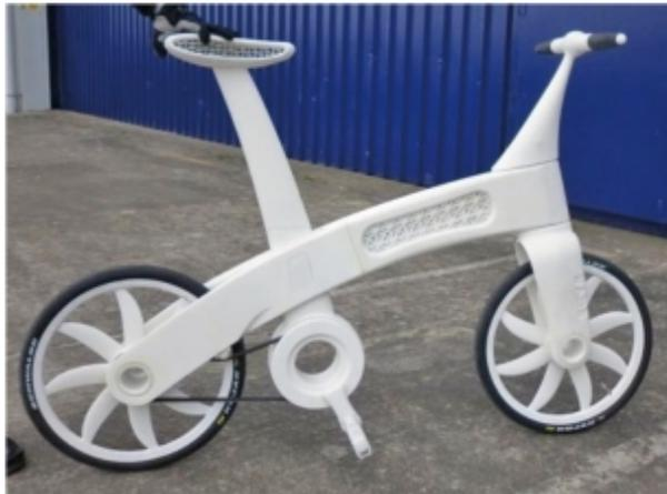
图4-1-5 尼龙材料自行车“Airbike”
