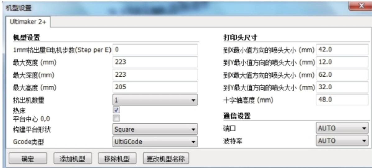
图3-2-2 机器设置的详细参数
