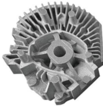
图2-2-3 SLS工艺打印的壳体
