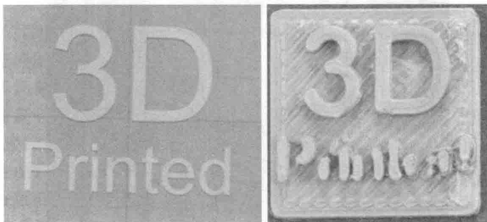
图 5-2-9 模型设计效果与模型 3D 细节丢失的打印效果
