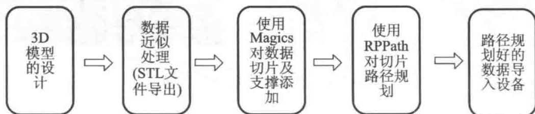
图 6-1-5 激光选区熔化工艺流程
