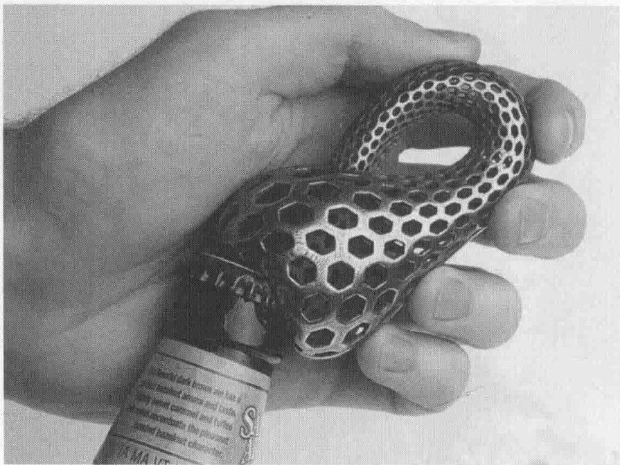
图 2-6 不锈钢材料 3D 打印的开瓶器
