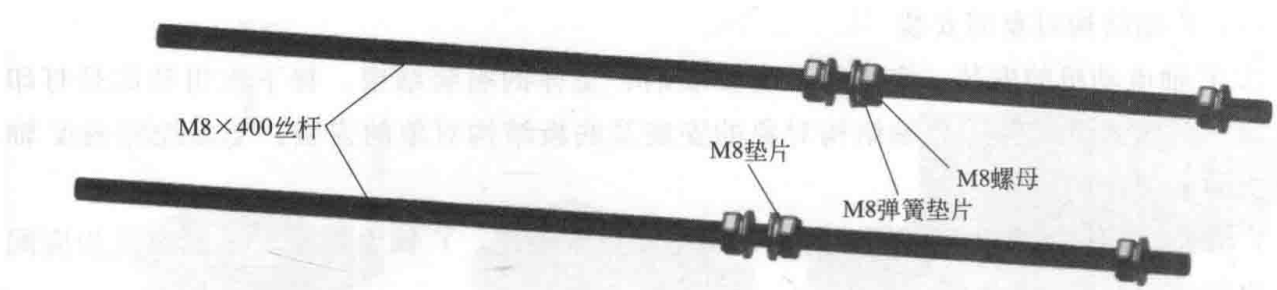
图 3-9 Y 轴丝杆安装过程
