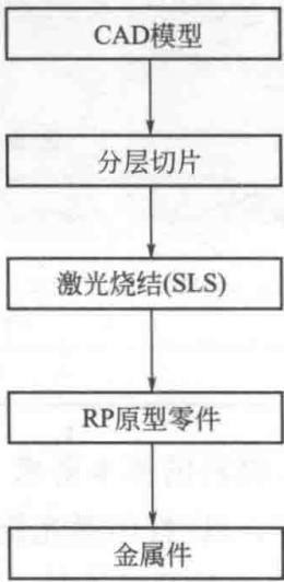
图 6-2 金属零件直接烧结工艺
