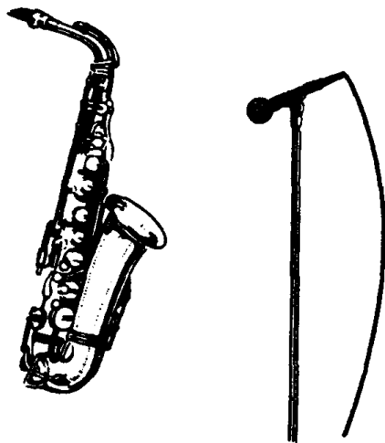
图4-40 萨克斯管拾音的传声器设置
