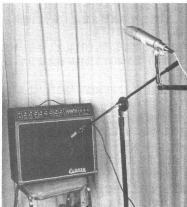
图 4-37 采用两只距离不等的传声器拾取 吉他扬声器重放的声音
