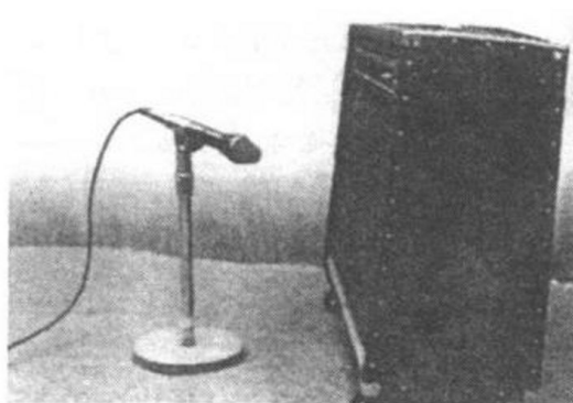
图 4-25 传声器轴向与电贝司扬声器呈一定角度拾音
