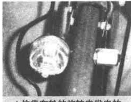
▲依靠车轮的旋转来发电的自行车发电机。
